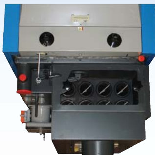
Blick von oben in den GSE Rauchgaswärmetauschers
