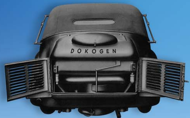
Škoda Modell Superb 1942 Holzvergasergenerator DOKOGEN
